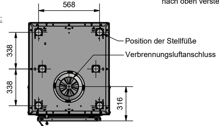
Alle Höhenangaben gelten bei einer Mörtelfugenstärke von 3 mm, einer Fasermattenstärke von 3 mm (im zusammengedrückten Zustand) und vollständig nach unten geschraubtem Grundgestell.
